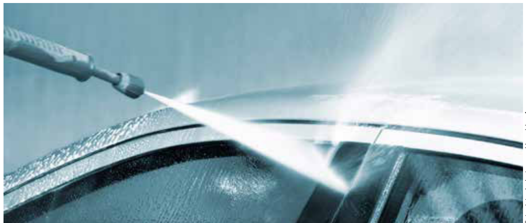
Auch das ist eine häufige Ursache für Feuchtigkeit im Wageninneren: Wer bei der Wäsche mit dem Hochdruckreiniger zu dicht ans Auto geht, beschädigt durch den Druck des Wasserstrahls die Gummidichtungen von Türen und Fenstern.
